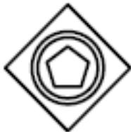
**Ereignis-basiertes Gateway:** Diesem Gateway folgen stets eintretende Ereignisse oder Empfänger-Aufgaben. Der Sequenzfluss wird zu dem Ereignis geleitet, das zuerst eintritt.
