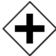
**Paralleles Gateway (UND):** Wenn der Sequenzfluss verzweigt wird, werden alle ausgehenden Kanten simultan aktiviert. Bei der Zusammenführung wird auf alle eingehenden Kanten gewartet, bevor der ausgehende Sequenzfluss aktiviert wird (Synchronisation).
